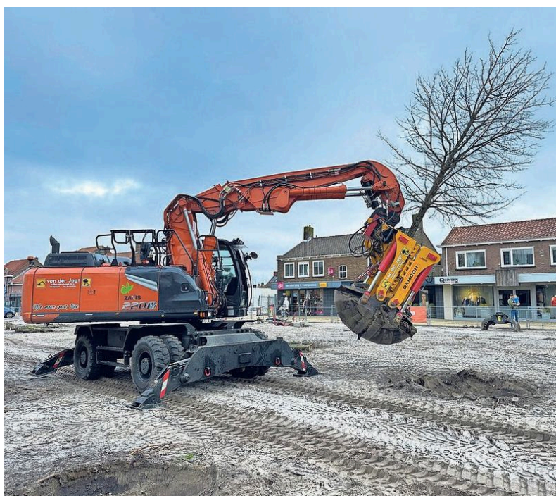
Dankzij de bomenverplantmachines hoeft het verplanten van bomen niet duur te zijn. FOTO MEDIAHUIS
