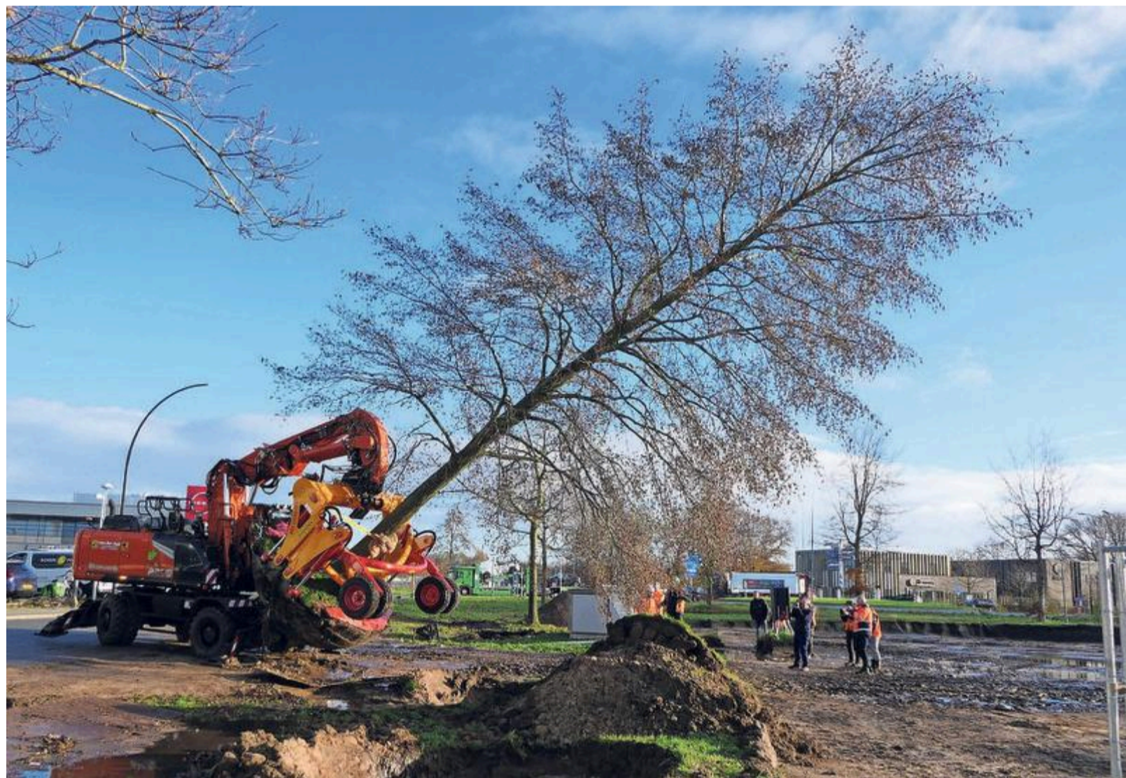
De nieuwe plantmachine van Van der Jagt Cultuurtechniek in actie. De schop heeft een diameter van 3,2 meter.
